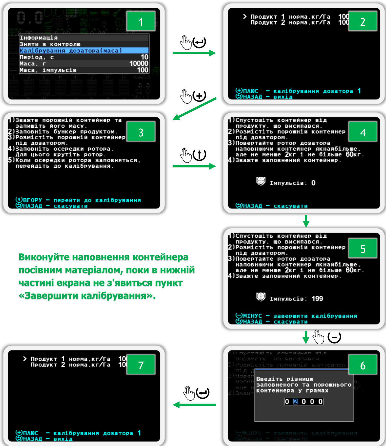
Малюнок 86 Калібрування дозатора для вимірювання маси посівного матеріалу
