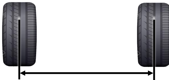
Малюнок 76 Вимірювання відстані між двох коліс для параметра «Ширина, см»
