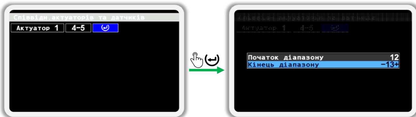
Малюнок 67 Меню створення додаткового діапазону секційних датчиків зв'язаних з актуатором створення технологічної колії
