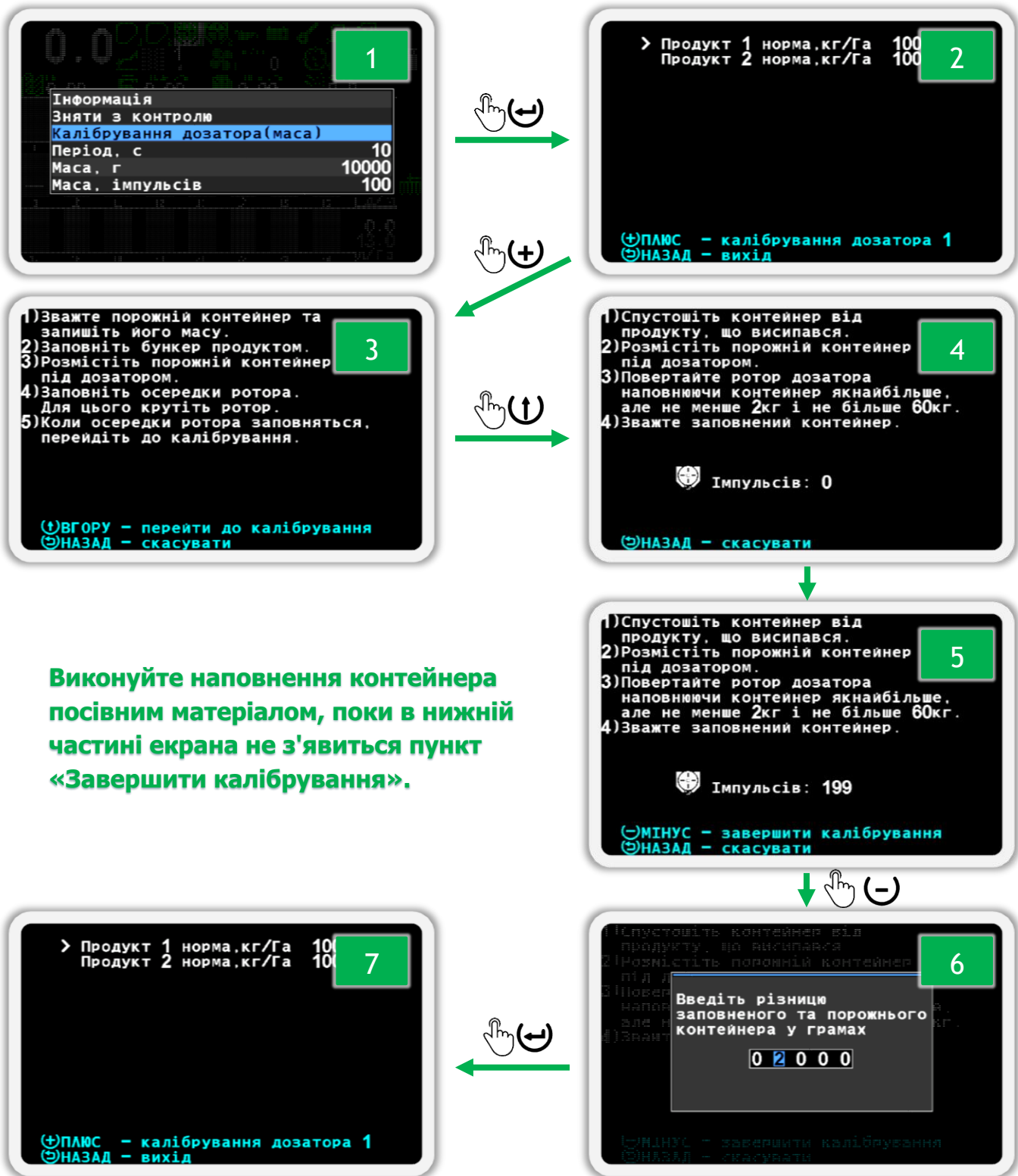
Малюнок 83 Калібрування дозатора для вимірювання маси посівного матеріалу
