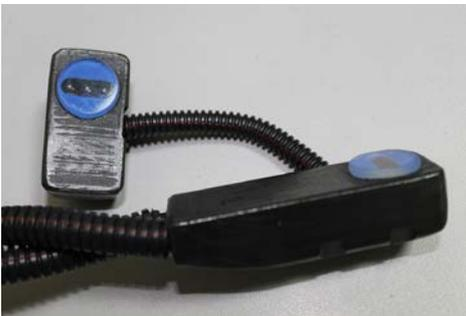
**Датчик пролета семян оптического типа.**
