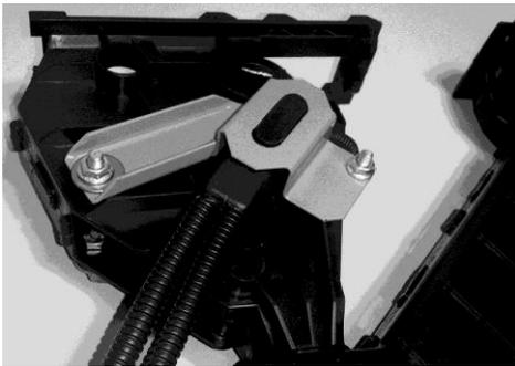
**Датчик пролета оптического типа встроенный, для механических сеялок.**
