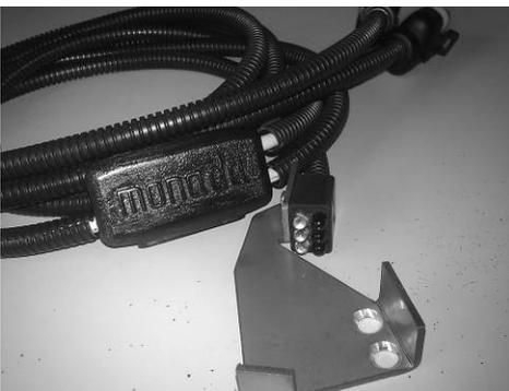
**Датчик пролета семян оптического типа с выносной оптикой на отражение**
